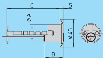
**Cilindro:** in ottone a lunghezza regolabile per serrature da applicare meccaniche ed elettriche.
